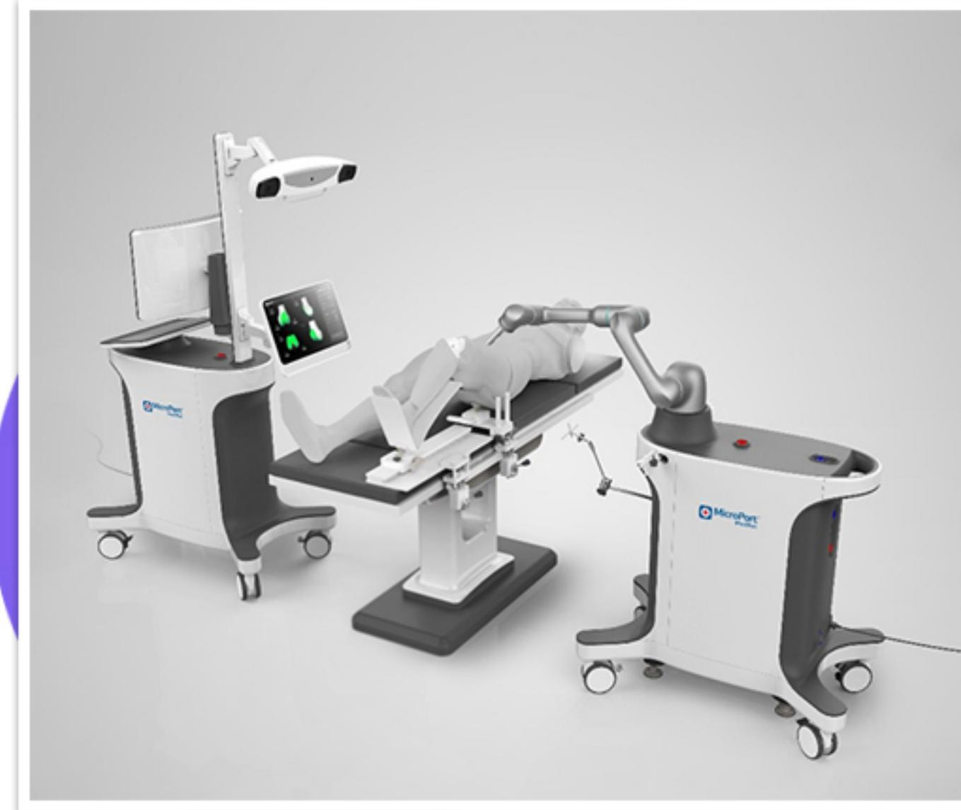
鸿鹄™Skywalker™骨科手术导航定位系统是一款用于全膝关节置换的手术机器人产品。相较于传统的关节置换手术，机器人辅助关节置换手术能帮助骨科医生解决手术中“看不到”“截不准”“拿不稳”的传统难题，实现更高的操作精度。鸿鹄™由手术平台、控制平台及手术附件组成，在术前诊断以及术中操作安全、便捷、交互体验等维度上给出了新颖且完整的解决方案。
